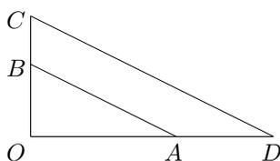
Repetimos la construcción a partir de  $\overline{OA} = 1 = \overline{OC}$  y de  $\overline{OB} = \beta$  para tener  $\overline{OD} = 1/\beta$ .
